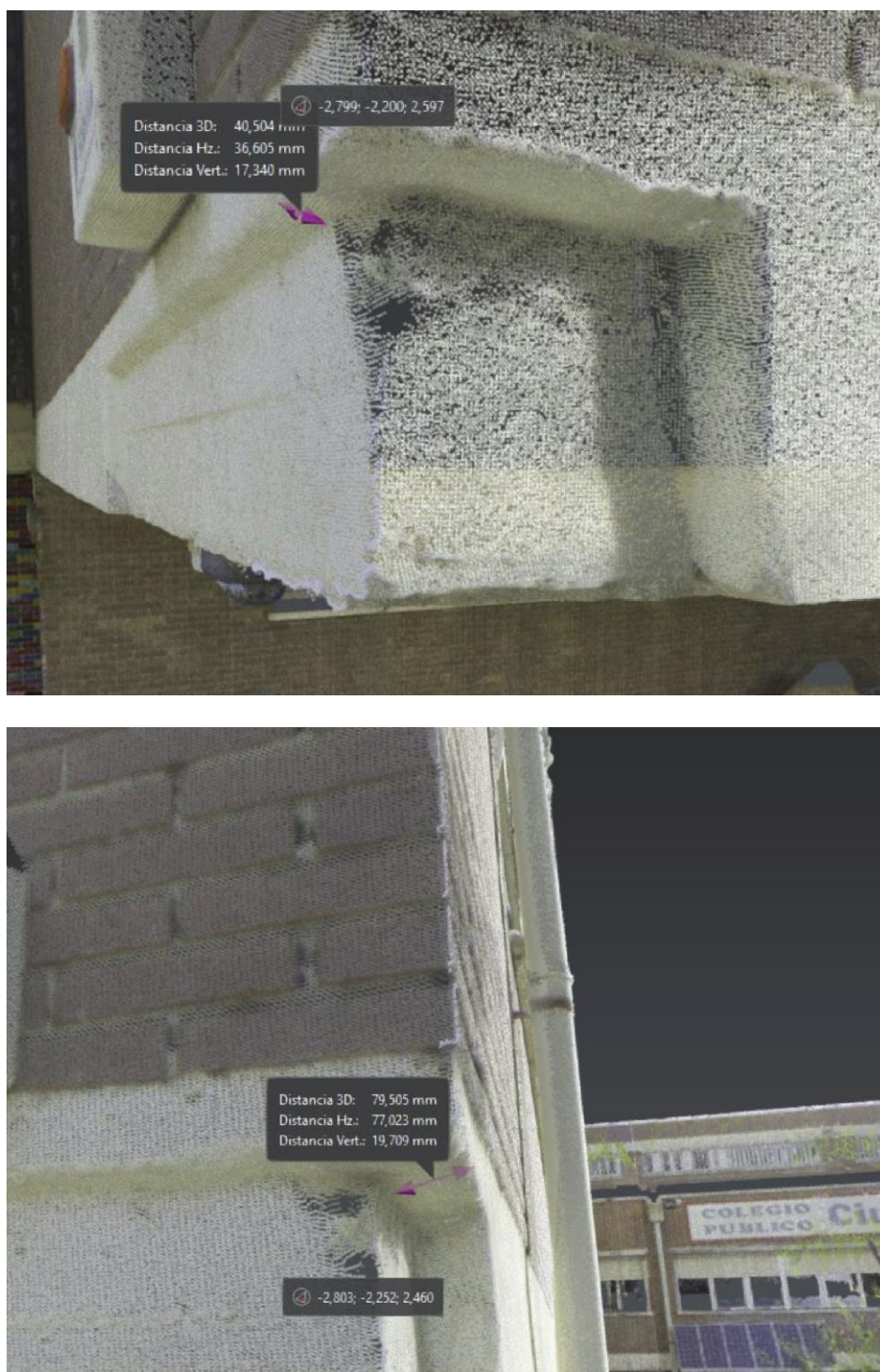
Figura 9. Replanteo mediante láser escáner del vuelo de la hoja exterior del cerramiento respecto del borde del forjado.
